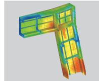
鋼製橋脚の地震時挙動解析
