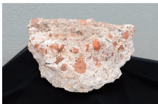
ローマ時代のコンクリート（約2000年前）
